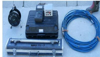
孔内傾斜計測定器
